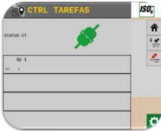
Com o controle ativo, o STATUS DO CT ficara verde e pronto para uso. Qualquer modificação feita nas configurações do módulo, o CTRL TAREFAS irá desconectar, então deixe para conectá-lo apenas no final das configurações.
